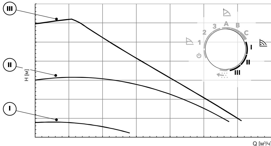
Режим работы с постоянной скоростью является наиболее распространенным вариантом при использовании в первичном контуре или контуре бойлера.
