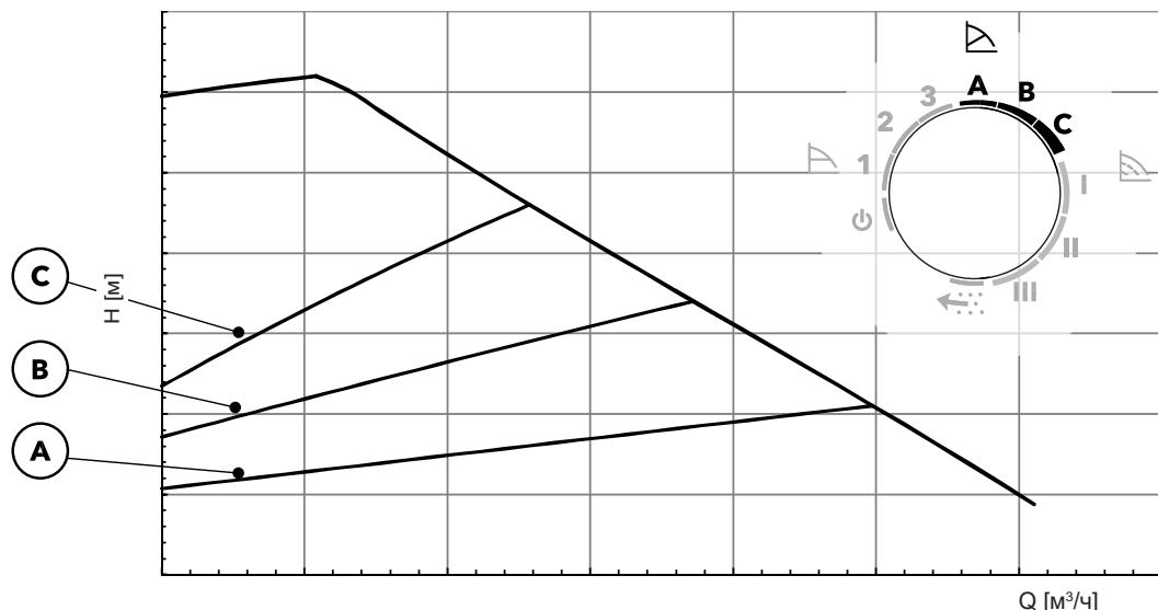
Функциональный режим пропорционального давления рекомендуется для систем с относительно большими потерями в распределительном трубопроводе, таких как **радиаторные отопительные системы**.
