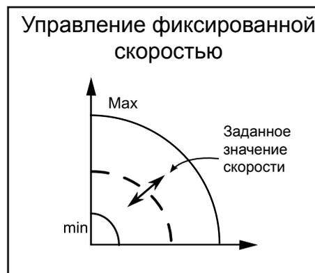
Насос поддерживает фиксированную скорость при любом необходимом расходе. Скорость насоса можно задать через пользовательский интерфейс. Постоянная скорость может быть большой при использовании в первичном контуре или контуре теплообменника в первичных/вторичных системах.
