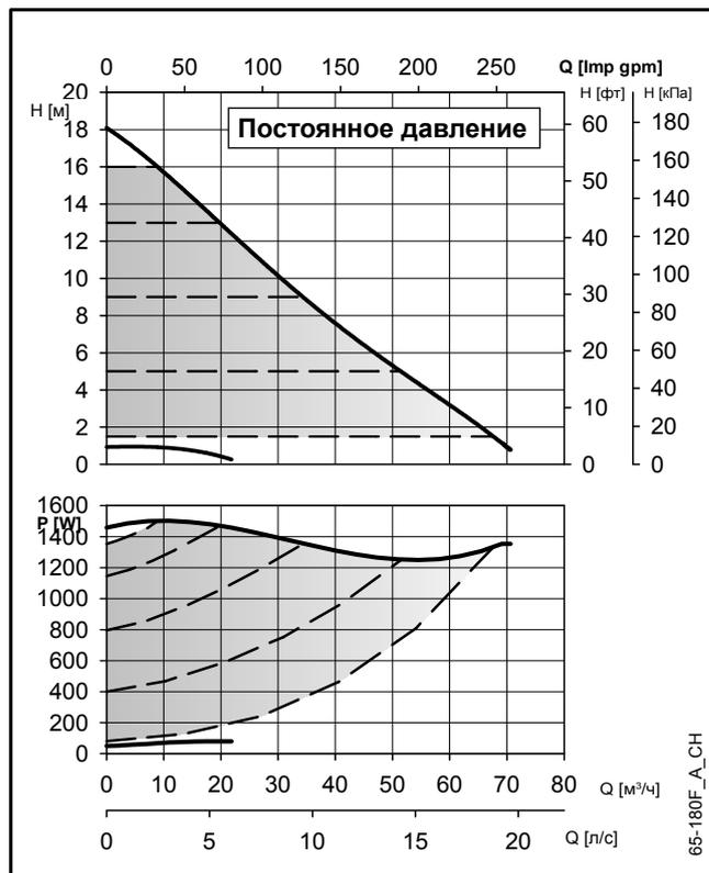
Эти показатели действительны для жидкостей плотностью  $\rho = 1,0 \text{ кг/дм}^3$  с кинематической вязкостью  $\nu = 1 \text{ мм}^2/\text{с}$ .
