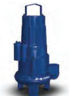
Lowara 1310 Vortex Макс. расход 16 л/с Макс. напор 16 м Мощ. двиг. 1,2 - 2,4 кВт Напорн. патрубок 50 - 80 мм Вес 46 кг
