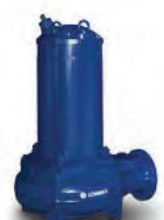
Lowara 1335 Non-clog Макс. расход 429 л/с Макс. напор 55 м Мощ. двиг. 18 - 50 кВт Напорн. патрубок 150 - 300 мм Вес 580 - 760 кг
